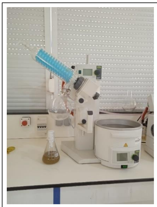
Figure 19 : Evaporateur rotatif utilisé pour l'élimination du solvant d'extraction
